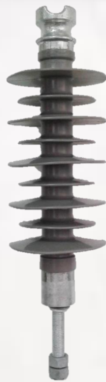
Aislador Rígido marca CAON-KORWI® Modelo ARSI-30E _ 36kV 6kN _C.D. 1000mm
