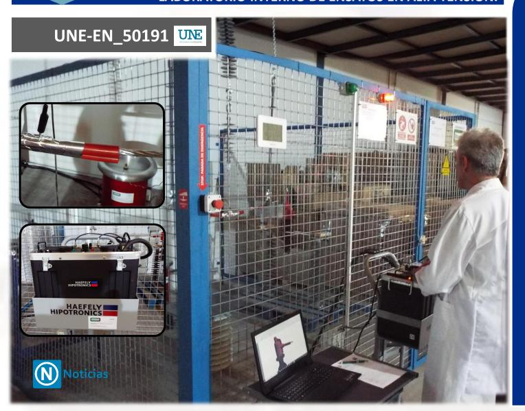
Ampliación de instalaciones con la puesta en servicio de un Equipo de Ensayos de Rigidez Dieléctrica de Alta Tensión.
